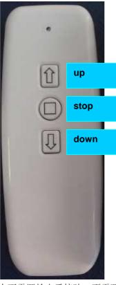
調換上下輸出控制:當接線柱的上下電源輸出反接時,不需要重新打開接線接收器外殼重新接線。只需按住向下鍵,再按住停止鍵,之后再按住向上鍵。**注意:在此操作按鍵切換時,LED 要保持常亮,即需要按下另外一个按鍵后再释放前一个按鍵。**
